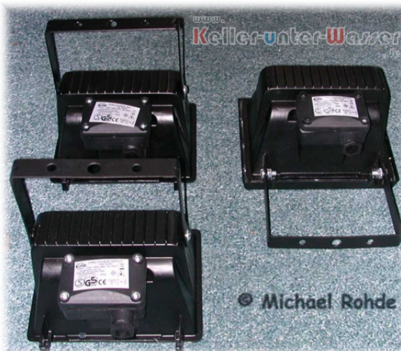
Abbildung 3: Umgebaute Strahler (links) und mit ursprünglicher Halterung (rechts).
